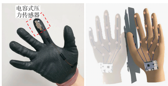
(a) 食指接压力传感器实物图 (b) 智能手套示意图 图 3 采用电容式压力传感器的电子智能手套示意图
