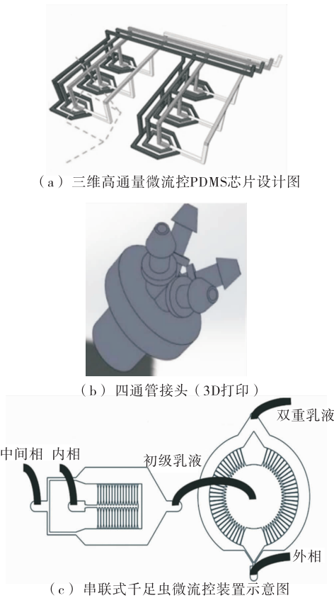
图9 微流控制备双重乳液高通量装置
