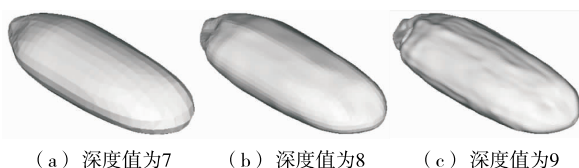
图 5 糙米表面点云数据的泊松重建效果
