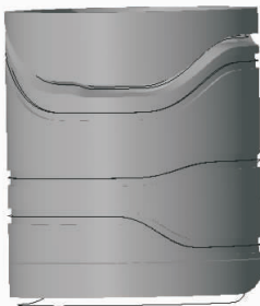
图8 多轨迹空间圆柱凸轮三维模型
