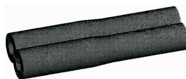
图 2 网格划分后的流场模型 Figure 2 Flow field model after mesh generation
